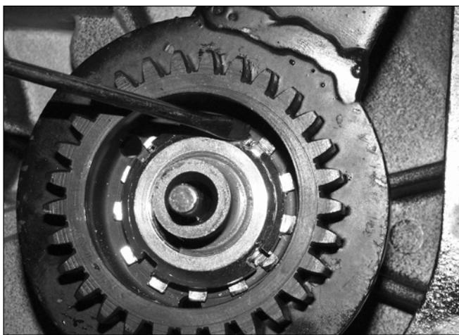
**Wiedereinbau des inneren Kupplungskörpers und der Kupplungssteuerungsgruppe auf die Welle Gehäusesseite**
