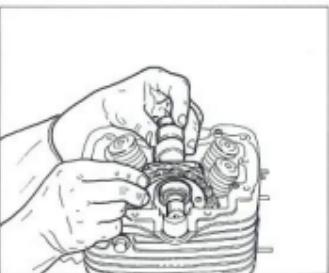
Dovendo procedere a uno smontaggio parziale dei componenti il gruppo termico, è necessario impedire alla catena distribuzione di cadere nel carter motore mantenendola sollevata con l'aiuto di un cacciavite.
