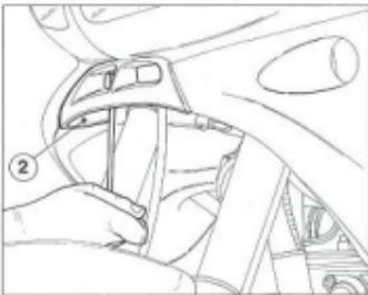
Svitare la vite (3) con bussola di fissaggio anteriore di ciascun fianchetto laterale al telaio di supporto proiettore.
