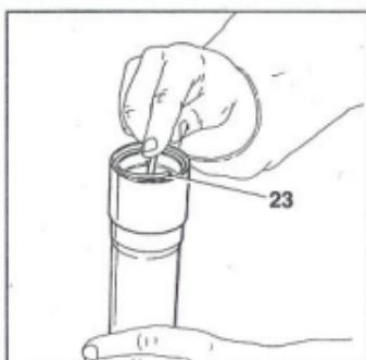
Utilizzando un cacciavite sottile rimuovere l'anello di fermo (23) dall'interno dello scorrivole.
