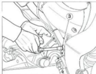
Allentare le viti (4) sui collari di tenuta dei silenziatori ai tubi di scarico. Sfilare i silenziatori dai tubi di scarico facendo molta attenzione a non rovinare la guarnizione presente nel punto di giunzione.
