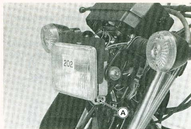
A. Headlight Adjuster Bolt
