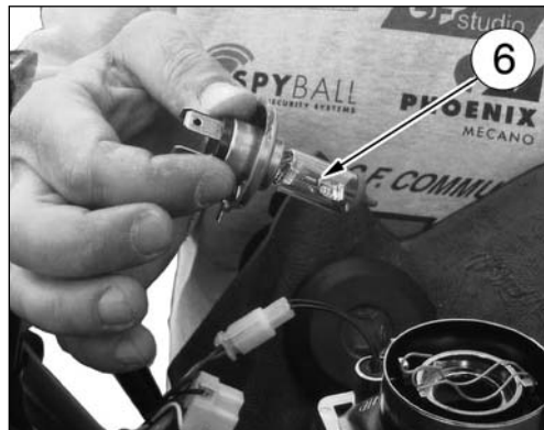
FIG. 37 6. Lampada biluce 7. Connettore 8. Lampada luce di posizione
