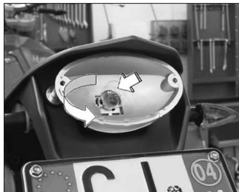
FIG. 39 1. Vite fiss. lente 2. Lente 3. Lampadina
