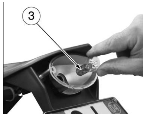
FIG. 39 1. Vis de fixation lentille 2. Lentille 3. Ampoule
