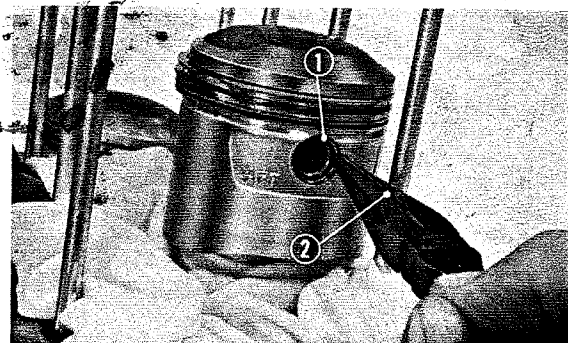
① Piston pin clip ② Pliers
