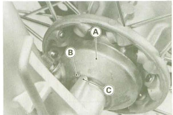
A. Meter Gear Housing
