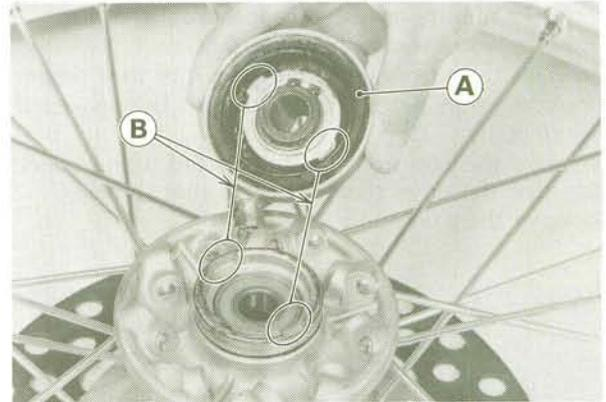
A. Meter Gear Housing
