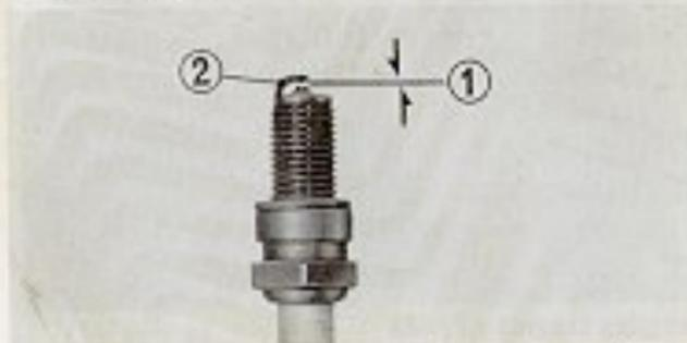
(1) Spark plug gap (2) Side electrode
