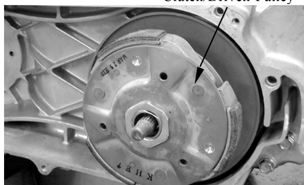
Clutch/Driven Pulley
